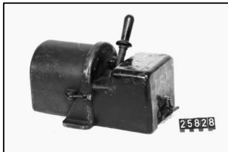
Pådragsmotstånd för elektrisk motor.
